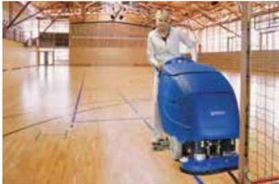
**Große Mitgänger-Scheuersaugmaschine mit hoher Reinigungsleistung**
