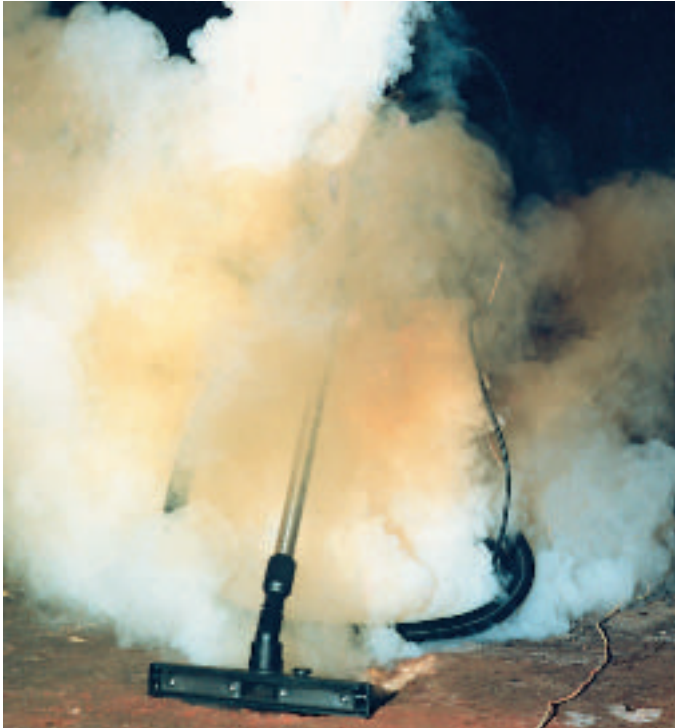
Bild 2: Abbrand von 100 g Treibladungspulverresten bei laufendem Motor
