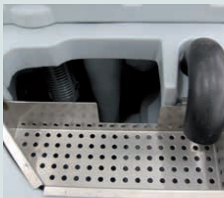
Neues Filtersieb für weniger Grobschmutz im Schmutzwasser.
