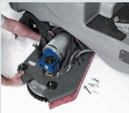
QuickChange™ System für werkzeuglosen Austausch der Bürsten und Sauglippen.
