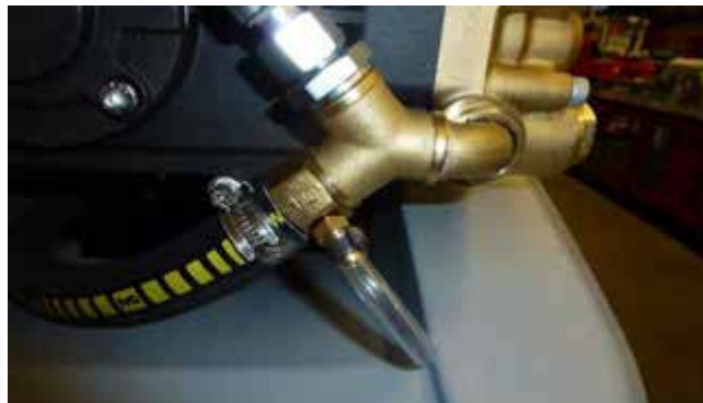
Rechtes Schlauchende wird mit einer 1-Ohr-Klemme 11,8
