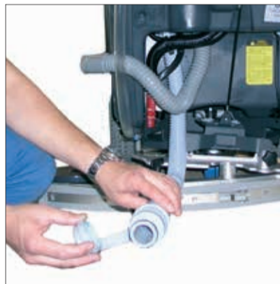
1. Saugschläuche wegen evtl. Verstopfung prüfen.
