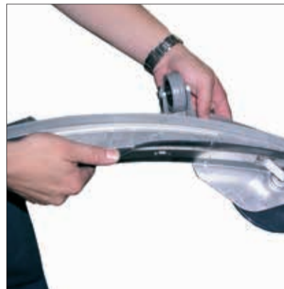
2. Prüfen auf Verunreinigung und Zustand der Absaugleiste und des Gummis.
