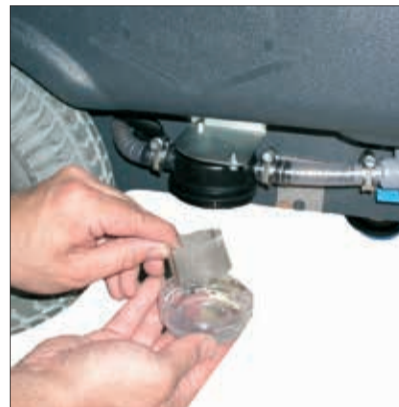
3. Reinigung und Kontrolle des Frischwasserfilters und des Saugschlauches.
