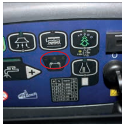
3. Kontrolle des Ladegeräts und Prüfung der Ladekabel.
