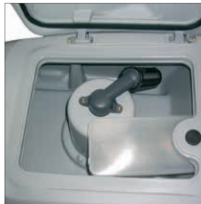
3. Abwassertank – Dichtung prüfen und ggf. reinigen.
