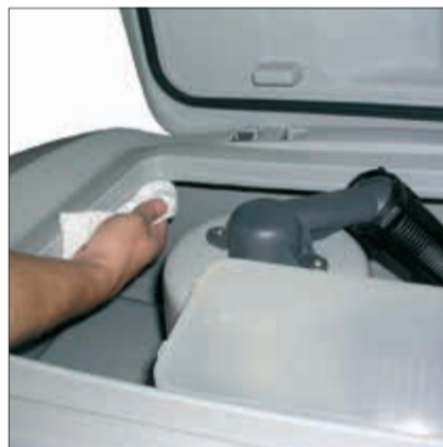
4. Abwassertank Dichtung prüfen und ggf. reinigen.
