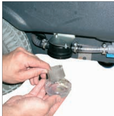
1. Überprüfen des Frischwasserfilters.
