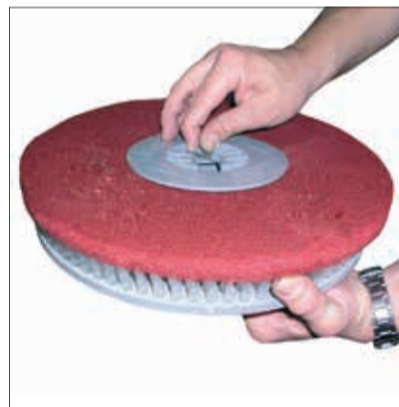
5. Reinigen der Bürsten oder Pads. Bei Verschleiß tauschen.
