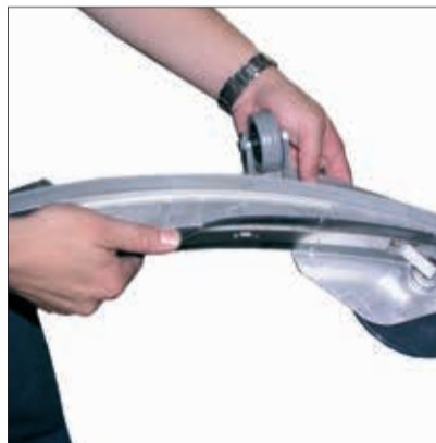
2. Sauplippen auf Verunreinigungen und Zustand prüfen.
