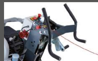
Führungsbügel mit Anti- Vibrationsschutz
