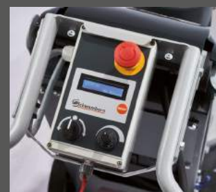
Display mit Leistungsanzeige und Betriebsstundenzähler
