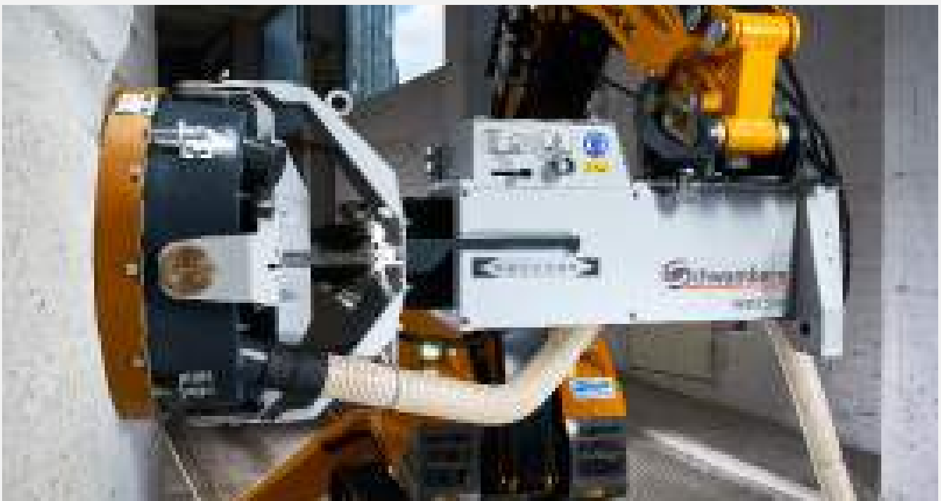
Immer planes Aufliegen des Schleifkopfes mittels Kardantechnologie garantiert beste Schleifergebnisse auch bei Neigungen bis zu 6 %
