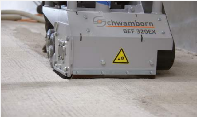
Grobe Unebenheiten von Industrieböden werden effizient abgefräst
