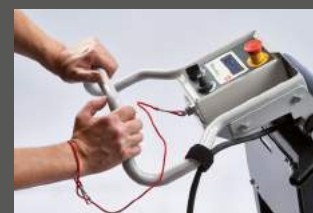
Totmannschalter für sicheres Arbeiten
