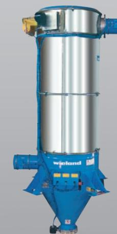
**Produktabscheider FiltroJet** in Ex-geschützter Ausführung für explosionsfähige Gase. Aufstellung in Zone 1. Herstellung von Granulat in der Chemieindustrie. Abfiltrieren von feinen Kunststoffstäuben. Fördermedium: brennbare Gase.
