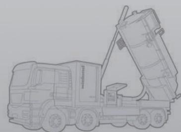
Auf Lkw oder Anhänger aufgebaute Sauganlagen von Wieland Lufttechnik. Die perfekten Alleskönner zum Aufsaugen großer Mengen trockener Schüttgüter, optional mit Verblasvorrichtung zur Druckentleerung. Sonderausführungen nach **ATEX** oder **ADR**.
