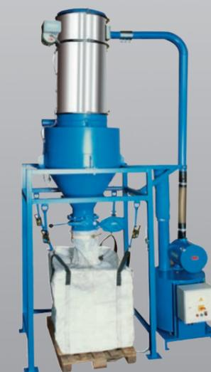
**BigBag-Abfüllanlage** füllt das Sauggut in BigBags. Produktabscheider FiltroJet, Seitenkanal-Vakuumpumpe, 11 kW, Sicherheitsfilter, Schalldämmgehäuse.
