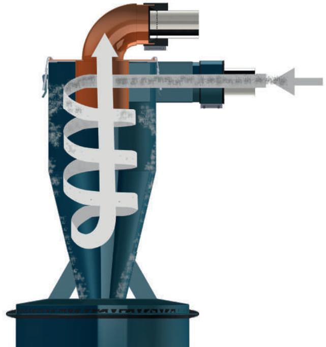
**Zyklonprinzip** bedeutet, dass der Einlass tangential angeordnet ist, so dass der Luftstrom an der Innenseite des Zyklonmantels rotiert.
