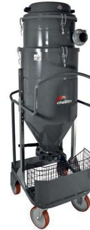
Der **Druckluftsauger DM 3 100 AIR** arbeitet mit einem wartungsfreien Antrieb nach dem Venturi-Prinzip und kann überall dort eingesetzt werden, wo keine elektrische Versorgung vorhanden oder nicht erlaubt ist. Die Venturi-Düsen befinden sich in einem robusten Saugkopf und sind so gegen äußere Einwirkungen geschützt. Eine Steuereinheit reguliert die Druckluftversorgung. Der Unterdruckanzeiger erlaubt die kontinuierliche Kontrolle des einwandfreien Betriebs und der möglichen Filterbelegung.
