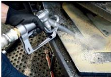
schnelle Entleerung der Flüssigkeit über Volumenstrom-Umkehrventil
