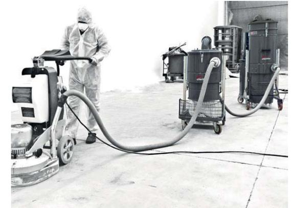
**AUT Automatisches Filterabreinigungssystem:** der eingebaute Kompressor reinigt effektiv den Sternfilter.
