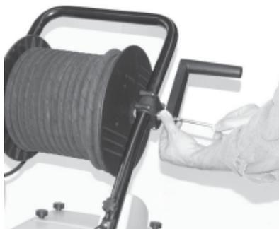
Schrauben Sie die Schraube aus der Antriebswelle der Schlauchtrommel. Packen Sie die Kurbel aus und stecken Sie sie auf den Sechskant. Befestigen Sie die Kurbel dann wieder mit der Schraube.
