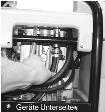
Soll für die Hochdruckreinigung Wasser aus einem externen Behälter angesaugt werden, so muß der Verbindungsschlauch zwischen Hochdruckpumpe und Schwimmerkasten abgeschraubt werden und der Saugschlauch direkt an der Pumpe angeschlossen werden.
