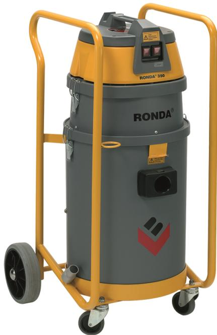
RONDA® 350 ist ein kompakter und sehr robuster Sauger mit eingebauter Pumpe für kontinuierlichen Betrieb und Auspumpen der aufgesaugten Flüssigkeit. Die Maschine ist für das Aufsaugen von größeren Mengen von sowohl reinem Wasser als auch schmutzigem Wasser mit einem kleineren Inhalt von Verschleißpartikeln gut geeignet. Die Maschine ist perfekt zur Beseitigung von Wasserschaden, im Baugewerbe, für das Aufsaugen von Kühlwasser bei Diamantbohrung/ Schneiden u.a.m.
