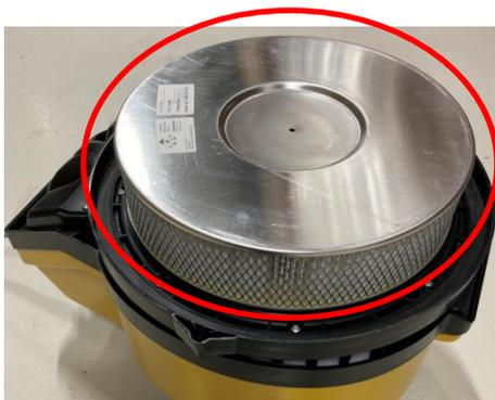
Der Motorkopf ist mit einem HEPA-Filter montiert. Der Filter hält die feinen und kleinsten Staubpartikel zurück, die vom Kanalfilter nicht zurückgehalten werden. Die Filteroberfläche von 2,2 m<sup>2</sup> wird von einem Metallgitter geschützt. Geprüft von IFA nach den Anforderungen für „Staubklasse H“.
