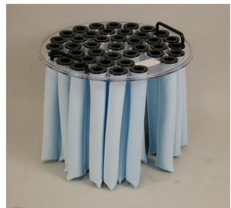
Der Filter besteht aus einer großen Anzahl von Hülsen (Kanälen), die über Federn gespannt sind. Während des Betriebes bewegen sich die Hülsen, und ein Teil des Staubes, der sich zur Filteroberfläche festsaugen kann, fällt im Auffangbehälter.
