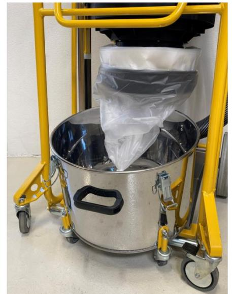
Während Betrieb muss die Maschine in abgesenkter Position gestellt werden mit dem Metallbehälter zum Schutz des Longopac.-
