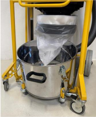
Nach der Leerung in den Beutel kann das Auffangen wiederaufgenommen werden, oder der Longopac Beutel kann (durch Anheben der Maschine und leichtes Herausziehen des Behälters mit Beutel und aufgesammeltem Material) mit einem Kabelbinder verschlossen und entsorgt werden.
