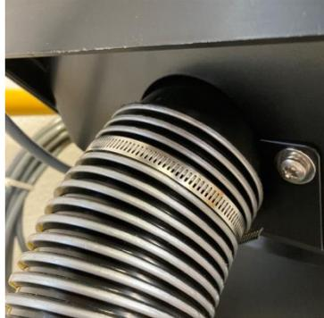
Verwenden Sie einen Abluftschlauch von min.  $\varnothing$  76 mm und mit einer max. Länge von 8 Metern.
