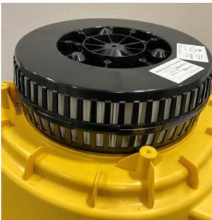
IFA zertifizierter HEPA-Filter der Klasse H ist im Motorkopf zum Filtern der Kühlluft für die Motoren angebracht.
