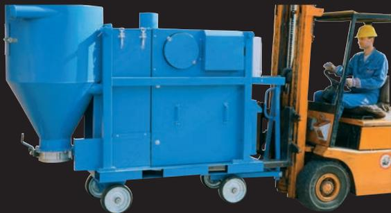
22 kW, Drehkolben-Vakuumpumpe, Förderleistung bis 10 t/h,
