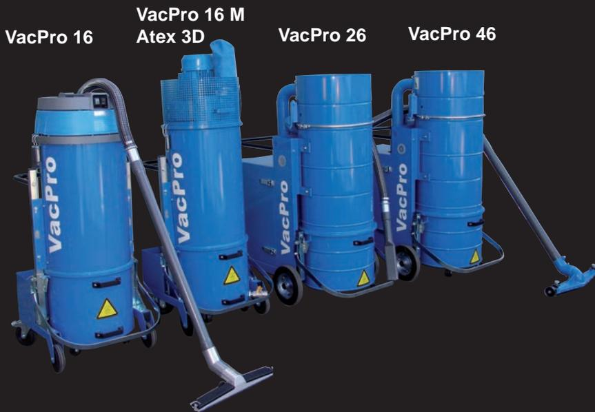
Fliehkraft-Abscheider entlastet den Hauptfilter weitgehend von Staub und vollständig von Flüssigkeiten (VacPro 26 und 46)
