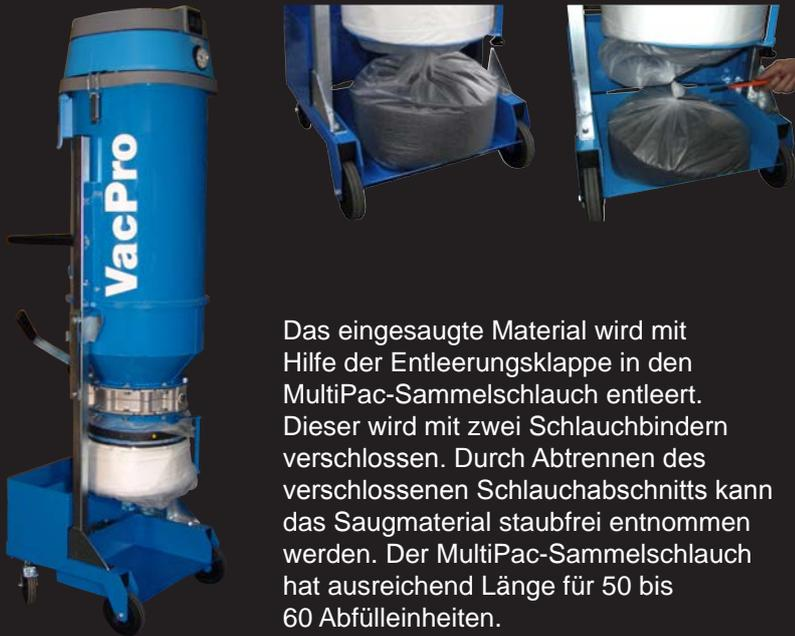
Das eingesaugte Material wird mit Hilfe der Entleerungsklappe in den MultiPac-Sammelschlauch entleert. Dieser wird mit zwei Schlauchbindern verschlossen. Durch Abtrennen des verschlossenen Schlauchabschnitts kann das Saugmaterial staubfrei entnommen werden. Der MultiPac-Sammelschlauch hat ausreichend Länge für 50 bis 60 Abfülleinheiten.
