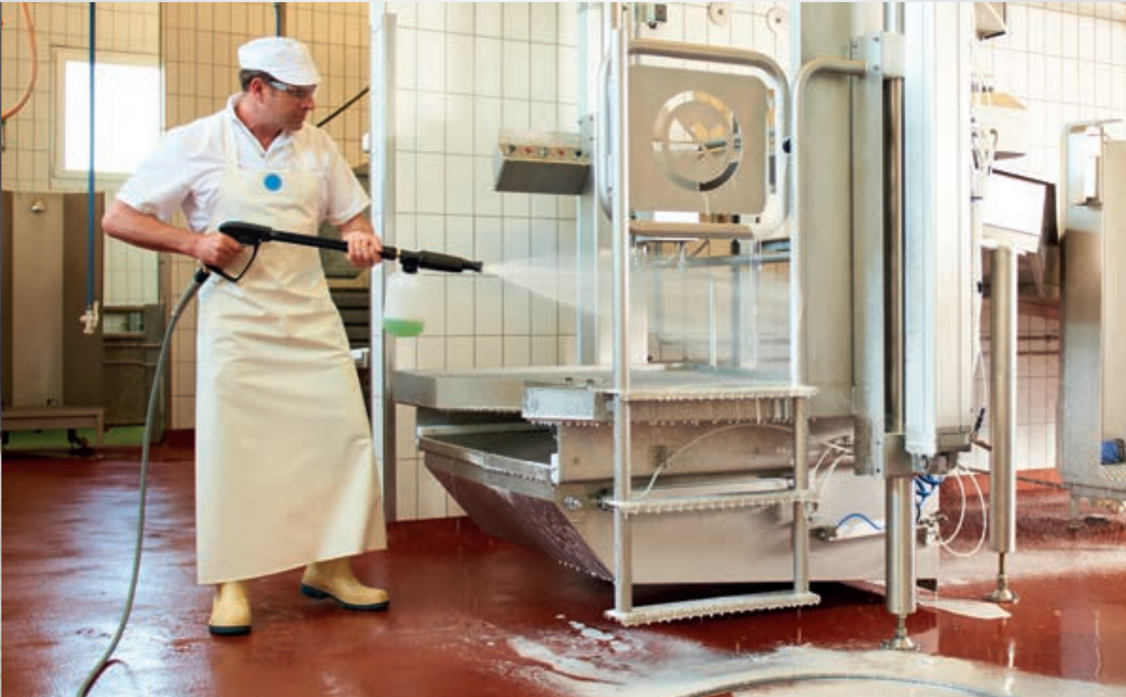
Abb. Sicherheits-Abschaltpistole mit Schauminjektor, Seite 75
