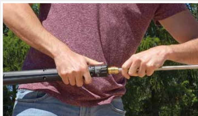
Fig. Version avec raccord fileté
