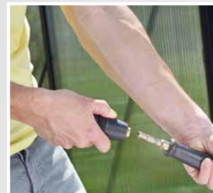
Fig. Version système d'échange par raccord rapide
