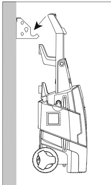
Der Druckreiniger kann an einer Wand auf einem Spezialhaken (nicht Standard) aufbewahrt werden.
