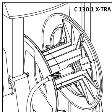
Der Hochdruckreiniger wird in zwei Modellen ausgeführt: A) mit einem Haken für die Aufbewahrung des Hochdruckschlauchs (14) - B) mit einer Schlauchwinde (13), wobei der Schlauch auf die Winde gedrückt und danach aufgewickelt wird.
