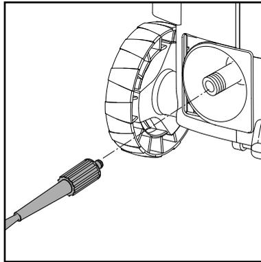
1. Montieren Sie den Hochdruckschlauch am Auslass (3).
