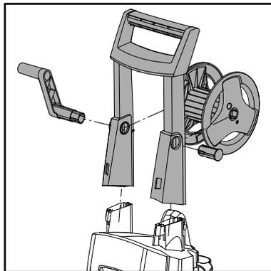
1. Tragegriff (12) auf der Maschine montieren.
