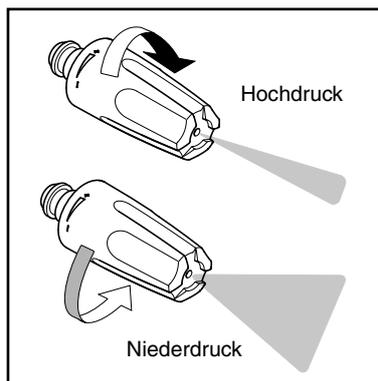
Der Druck kann auf der TORNADO® PR Düse eingestellt werden.
