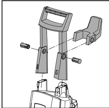
1. Tragegriff (12) auf der Maschine montieren.
