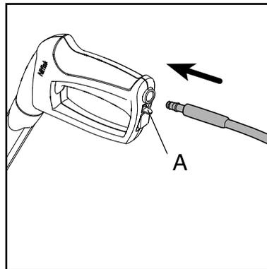
Den Hochdruckschlauch (4) an der Spritzpistole (7) montieren.
