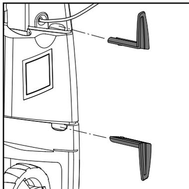
1. Drücken Sie die Leitungshalter (17) in die Maschine.
