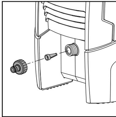
1. Schrauben Sie die Schnellkupplung fest an den Wasserzulauf (2) an.
