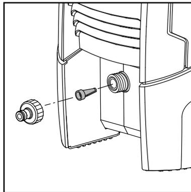
Lockern Sie den Filter sorgfältig mit einem Schraubenzieher und reinigen Sie ihn. Vergewissern Sie sich, dass er intakt ist, bevor Sie ihn wieder einsetzen.
