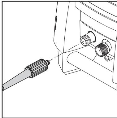
*Modelle ohne Schlauchtrommel:* Den Hochdruckschlauch (4) in den Anschlussstutzen des Gerätes (3) einführen.
