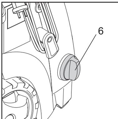
Am Gerät können Arbeitsdruck und Wassermenge durch Drehen des Druck-/Wassermengenreglers (6) eingestellt werden.
