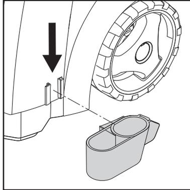
Die Sprührohrhalter auf dem Gerät montieren.
