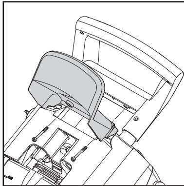
Den Schlauchhaken (14) auf dem Gerät montieren (2 Schrauben).
