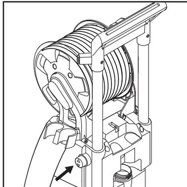
Das Gerät hat einen Teleskopgriff. Um den Griff zu heben oder senken, die Taste (16) drücken und den Griff aufwärts oder abwärts bewegen. Sicherstellen, dass er einrastet.
