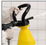
8. Wasserhahn öffnen und Schaumproduktion starten indem Sie die Pistole betätigen.
