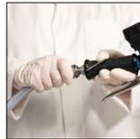
6. Wasserschlauch mit 1/2" Schnellkupplung (0701) an die Pistole anschließen.
