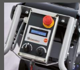
Display mit Leistungsanzeige und Betriebsstundenzähler
