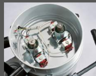
Automatische mechanische Filterreinigung
