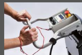
Totmannschalter für sicheres Arbeiten
