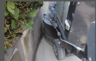
Randnahes Schleifen mit der Fernbedienung
