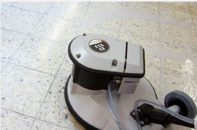
Die Kristallisation veredelt einen gereinigten, kalkhaltigen Boden dauerhaft
