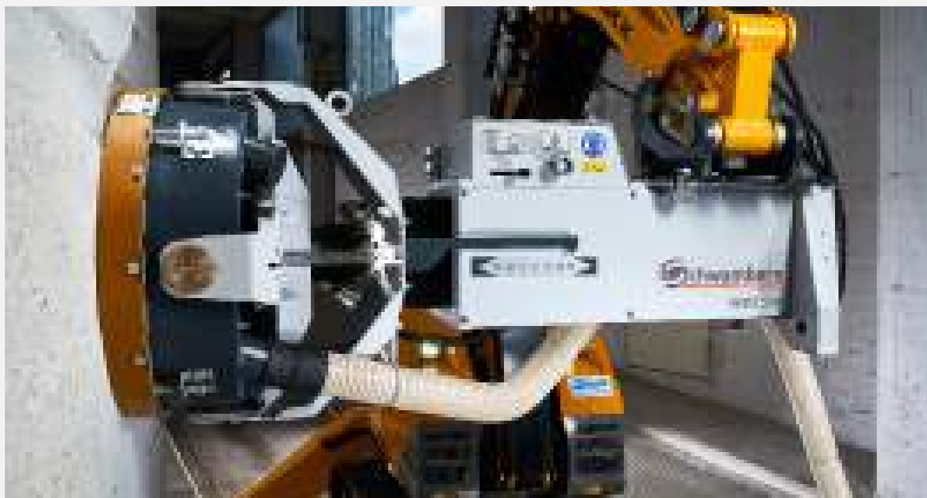
Immer planes Aufliegen des Schleifkopfes mittels Kardantechnologie garantiert beste Schleifergebnisse auch bei Neigungen bis zu 6 %
