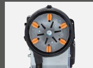
Zwei Schleifdurchmesser (170 und 250 mm)
