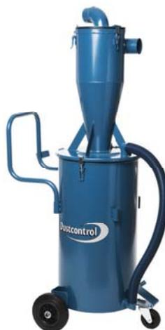
Der DCF Mobile mit Zyklon besitzt einen hocheffizienten Zyklon auf dem Verschlussdeckel. Aufgrund seines relativ geringen Durchmessers, seiner verhältnismäßig großen Höhe und des speziell ausgeführten Einlasses kann dieser Vorabscheider auch feines und leichtes Material, z. B. Asbestfasern, abscheiden. Das abgeschiedene Material fällt anschließend in den Behälter, der mit einem Kunststoffstoffsack ausgestattet ist, um es staubfrei zu entsorgen.
