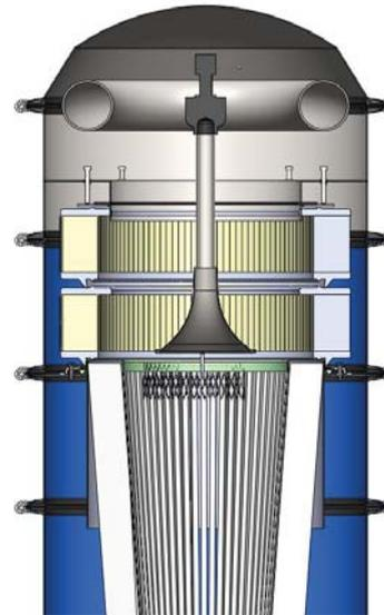
Mit der Hilfe eines Filters können fast alle Partikel eliminiert werden. Die Installation kann durch weitere Kanäle und optionale Schalldämmung ergänzt werden.
