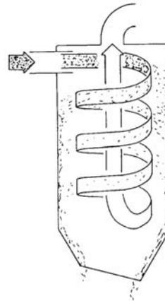
**Zyklonprinzip:** Der Einlass ist tangential angeordnet, sodass der Luftstrom an der Innenseite des Zyklonmantels entlang strömt.
