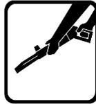
Das Sprührohr ist während des Betriebs einer Schubkraft ausgesetzt. Halten Sie es daher immer fest mit beiden Händen. **WICHTIG: Halten Sie die Düse so, dass sie zum Boden weist.**
