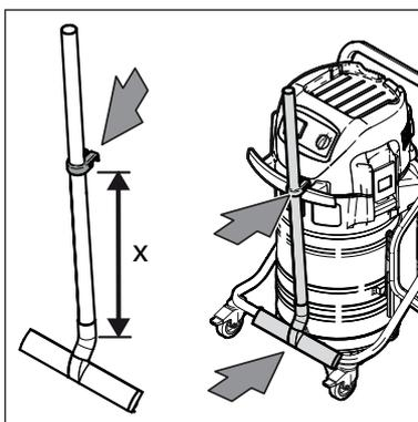
1. Saugrohrhalter am Saugrohr befestigen.
