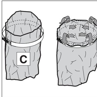
4. Entsorgungssack (C) in den Spannring einsetzen.
