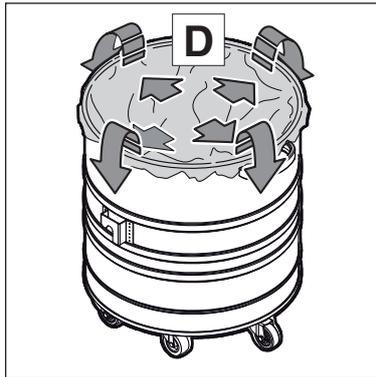
5. Entsorgungssack (D) in den Schmutzbehälter einsetzen.
