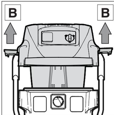
3. Verschlussklammern (B) öffnen und Saugerteil abnehmen.
