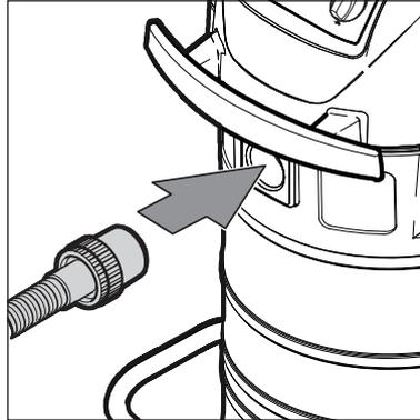
1. Saugschlauch am Sauger anschließen.
