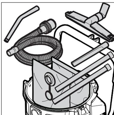
4. Verschlussklammern (B) öffnen und Saugeroberteil abnehmen.
