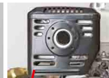
groß dimensionierter Schalldämpfer zur deutlichen Minderung des Betriebsgeräusches
