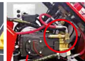
Pumpentemperaturüberwachung: Erreicht die Temperatur der Pumpe 85 °C, schaltet sich das Gerät ab
