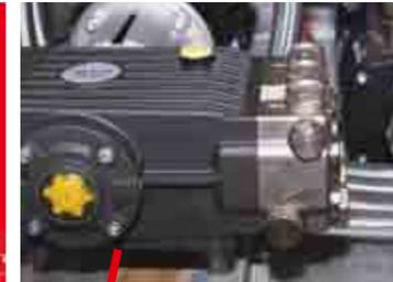
heißwasserbeständige Triplex-Kolbenpumpen mit Chromstahl-Pumpenkopf, Keramik-Plungern und Edelstahl-Ventilen
