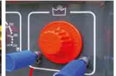
Regelventil für die stufenlose Beimischung von Zusatzmitteln
