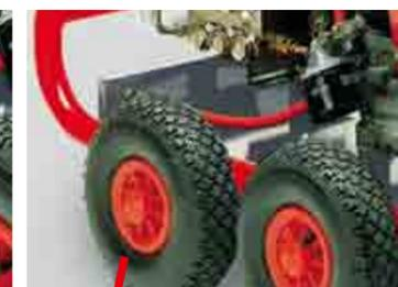
geländegängiges Fahrgestell mit luftbereiften Rädern für leichtes Bewegen und zur Schwingungsdämpfung
