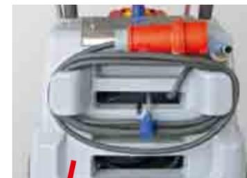
Multifunktionsablage für 5,5 m Elektrokabel und Zusatzmittelschlauch
