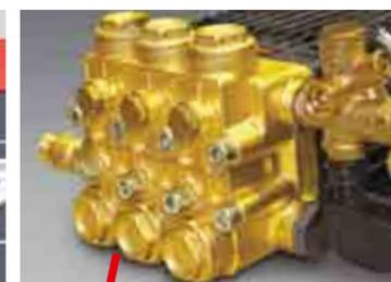
heißwasserbeständige Triplex-Kolbenpumpe mit Messing-Pumpenkopf, Keramik-Plungern und Edelstahl-Ventilen (nur KS 1040)
