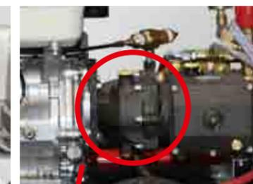
Vorschaltgetriebe zur Reduzierung der Pumpendrehzahl (Untersetzung 1:2,2)
