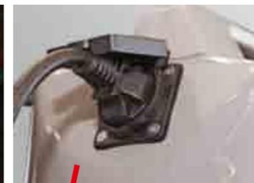
WZ-Versionen mit Gerätesteckdose mit Anlauf- und Abschaltverzögerung zum Anschluss absaugbarer Elektrogeräte
