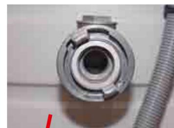
Feuerwehranschluss - Storz 52-C - zum Flüssigkeitsabpumpen mit Rückschlagventil
