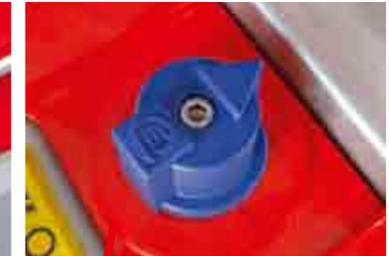
Regelventil für die stufenlose Beimischung von Zusatzmitteln
