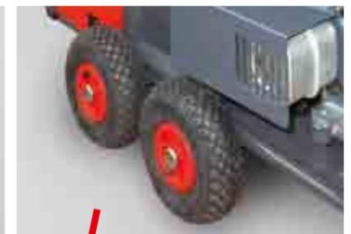
geländegängiges Fahrgestell mit luftbereiften Rädern für leichtes Bewegen und zur Schwingungsdämpfung
