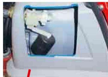
das rotationsgeformte Chassis ist hohl und dient als Wasserspeicher (17 l) und -puffer sowie zur Netz-trennung
