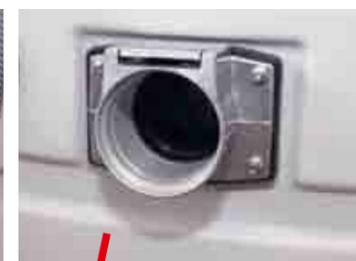
robuster Saugschlauchanschluss aus Metall
