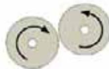
Ungleichmäßiges, nur in einer Richtung verlaufendes Scheuern mit herkömmlichen Scheibemaschinen
