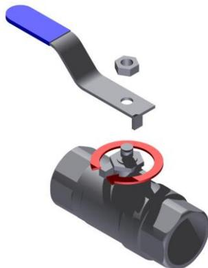
Die Spindelmuttern an den Kugelhähnen sind regelmäßig nachzuziehen.
