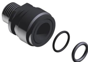
Es empfiehlt sich, die Kupplungen zu reinigen und regelmäßig zu fetten, um Undichtigkeit oder Beschädigung von Dichtungen zu vermeiden. Es ist darauf zu achten, dass sich stets Düsen in der Kupplung zur Pistole bzw. zum Ventil befinden, da sonst die O-Ringe herausgespült werden bzw. Wasser dahinter dringt, so dass sich die Düsen nur schwer einsetzen lassen.
