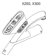
**Fernbedienung am Schlauchgriff – Batteriewechsel, Batterietyp CR2032**
