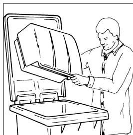
**2.5 Når maskinen ikke skal benyttes lenger****2.5.1 Tømming av smussbeholderen**
