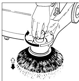
Håndfeiemaskinen er ved levering innstilt til bruk på glatte, jevne flater.
