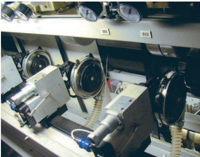
Saughauben an Schneidmessern von Druckmaschinen
