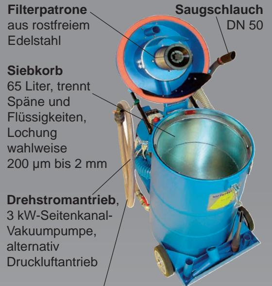
**Druck-Entleerungsschlauch** für Flüssigkeiten, Kugelhahn, (keine wartungsintensive Pumpe erforderlich)
