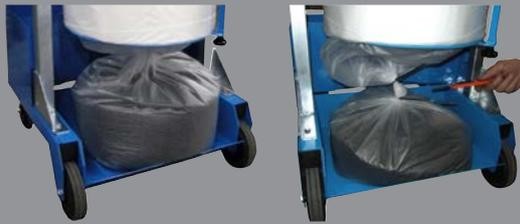
Das eingesaugte Material wird mit Hilfe der Entleerungsklappe in den MultiPac-Sammelschlauch entleert. Dieser wird mit zwei Schlauchbindern verschlossen. Durch Abtrennen des verschlossenen Schlauchabschnitts kann das Saugmaterial staubfrei entnommen werden. Der MultiPac-Sammelschlauch hat ausreichend Länge für 50 bis 60 Abfülleinheiten.
