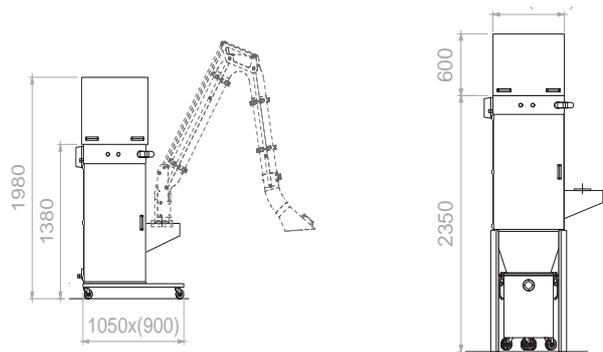
Varianten: mobile oder stationäre Ausführung möglich
