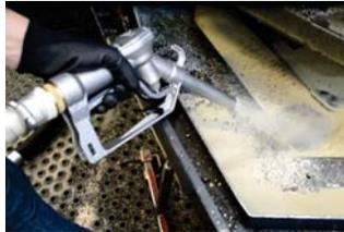
schnelle Entleerung der Flüssigkeit über Volumenstrom-Umkehrventil
