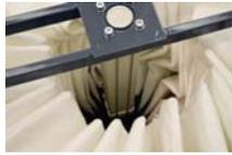
Filterabreinigungssystem mit eingebautem Kompressor
