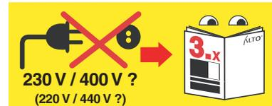
Bei Geräten mit **Spannungsumschaltung** unbedingt darauf achten, dass die korrekte Netzspannung am Gerät eingestellt ist, bevor der Netzstecker in die Steckdose gesteckt wird. Andernfalls können die elektrischen Bauteile des Gerätes zerstört werden.
