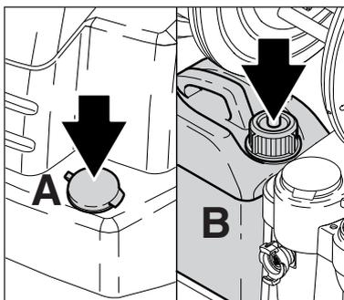
1. Reinigungsmittel tanks (A) und (B) mit Nilfisk-Alto-Reinigungsmittel füllen.
