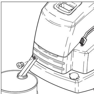
1. Behälter bereitstellen, der geeignet ist, die gesamte Menge des Tankinhalts aufzunehmen.
