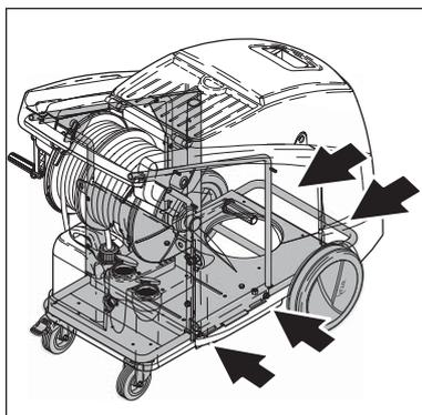
1. Die sicherste Art und Weise, die Maschine zu heben ist die Verwendung eines Gabelstaplers. Die Pfeile kennzeichnen die günstigsten Einfahrpunkte für die Gabel.
