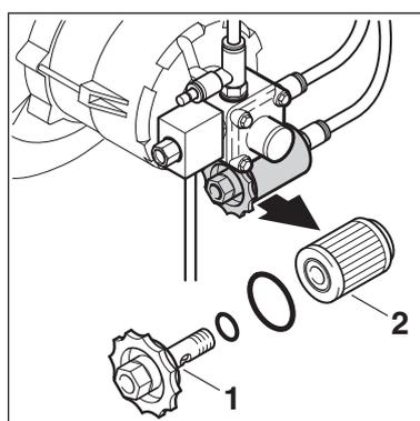
1. Filter reinigen/erneuern: Filterdeckel (1) abschrauben
