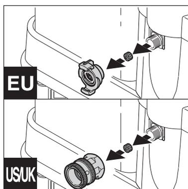
Im Wasserzulauf sind zwei Siebe montiert die größere Schmutzpartikel zurückhalten, damit diese nicht in die Hochdruckpumpe gelangen.
