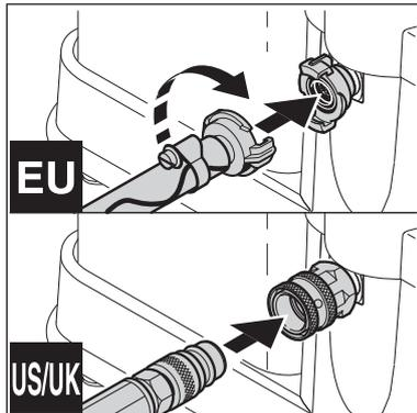
1. Beigelegte Schlauchtülle an den Wasserschlauch montieren.
