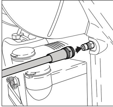
1. Hochdruckschlauch mit Schnellkupplung am Hochdruckanschluss des Gerätes anschließen.
