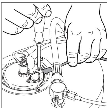
1. Sensor herausnehmen und mit einem weichen Tuch reinigen.
