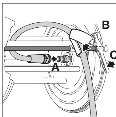
1. Anschlusskupplung (A) des Hochdruckschlauchs auf den Nippel in der Achsenmitte stecken.
