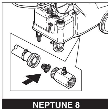
3. Filter im Hochdruckpumpen-Eingang reinigen.
