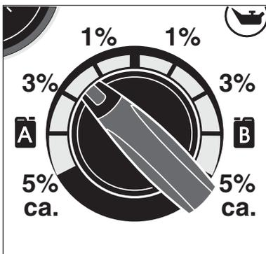
1. Gewünschte Konzentration des Reinigungsmittels (A) oder (B) am Dosierventil einstellen.
