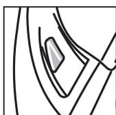
Die Füllstandsanzeige des Staubbeutels. Wenn die Anzeige vollkommen rot ist, muss der Staubbeutel gewechselt werden, damit kein Motorschaden entsteht.
