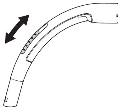
Die Saugkraft lässt sich ebenfalls durch Verwendung des Schiebereglers auf dem Staubsauger regeln. Das Symbol auf dem Regler zeigt die Richtung für maximale und minimale Saugkraft an.
