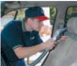
Mit konstantem Druck und konstanter Wassermenge werden Teppichböden und Polsterbezüge bei der Reinigung geschont und behalten so langfristig ihren Wert.
